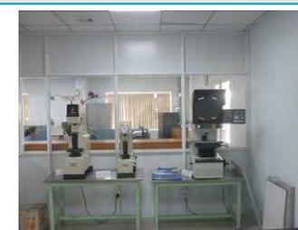
ブリネル硬度計 ロックウェル硬度計 投影機
